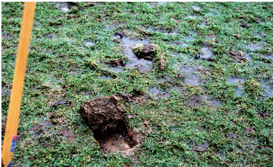
Abb. 53: Unter der plastischen, verformten Oberschicht befindet sich ein verdichteter, relativ trockener Boden.
